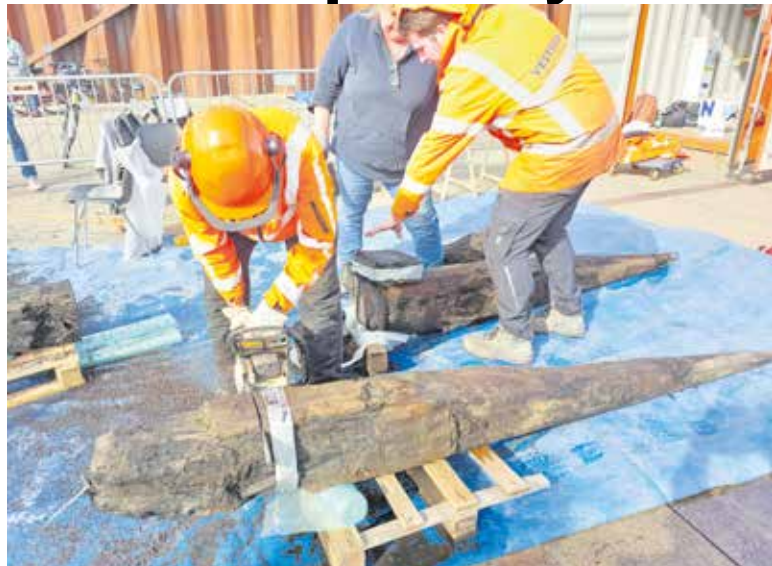
Eén van de opgegraven palen uit de Maas wordt door midden gezaagd om de leeftijd te bepalen.
